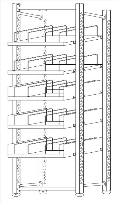
Принцип действия гравитационных стеллажей состоит в самостоятельном передвижении товаров по рабочей поверхности. Поставленный предмет скользит по поверхности под действием силы тяжести. Первый загруженный на полку стеллажа товар поступает первым на место выгрузки.
